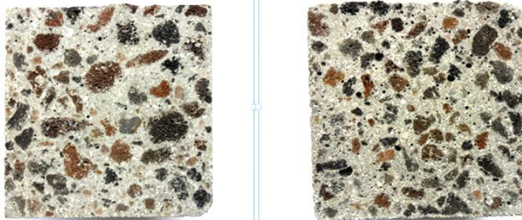
شکل ۵- پروفیل بتن سخت شده، تصویر سمت راست (mix2) و تصویر سمت چپ (mix5)
