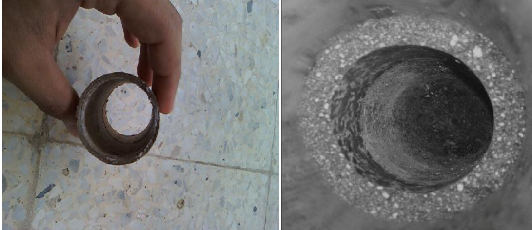
شکل ۴- سطح مقطع نازل بتن پرلیتی (سمت راست) سطح مقطع نازل مقوای فشرده (سمت چپ)
