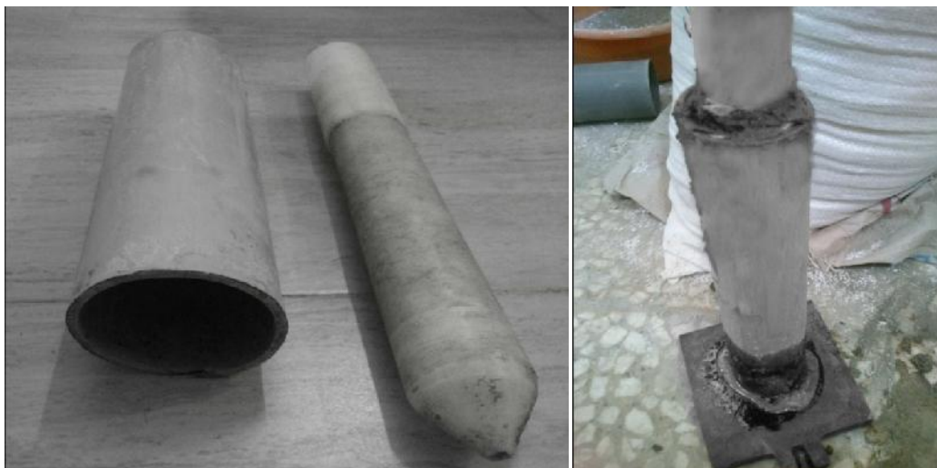
شکل ۴- قالب های بتن ریزی (سمت چپ) بتن ریخته شده در قالب (سمت راست)
