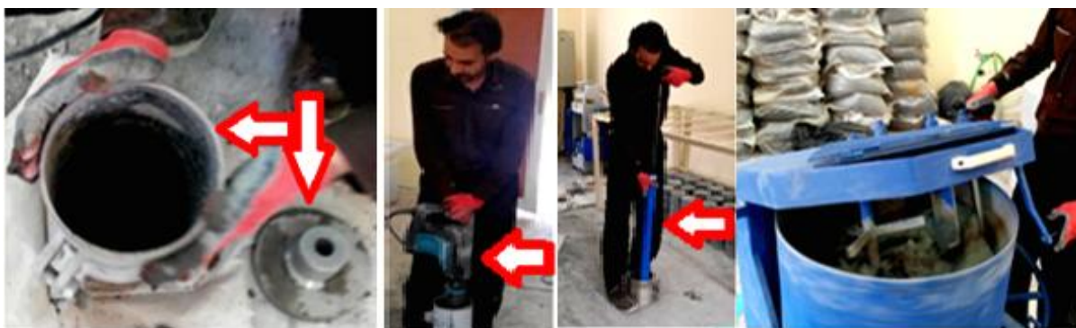
شکل ۲. ساخت مخلوطها و آماده‌سازی نمونه‌ها (تصاویر از چپ پن میکسر استفاده شده، تعیین جرم حجمی با چکش پراکتور، نمونه‌سازی با چکش ۱۰ کیلوگرمی و قالب استوانه‌ای و کوبه تراکم)
