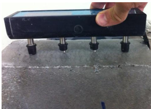
شکل ۱- دستگاه اندازه گیری مقاومت الکتریکی ۴ نقطه‌ای
