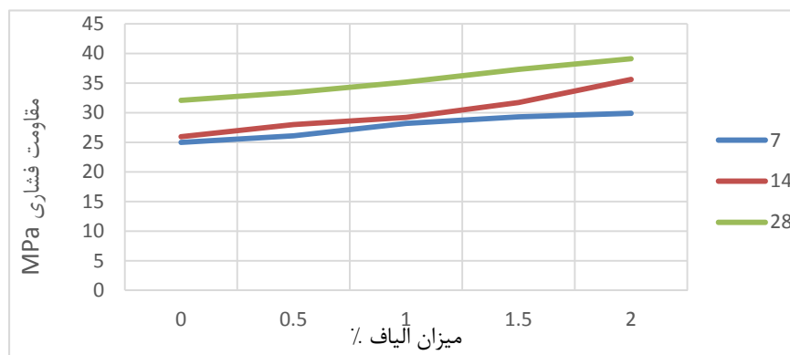
شکل ۴. نتایج آزمایش مقاومت فشاری برای نمونه‌های حاوی الیاف نایلون.
