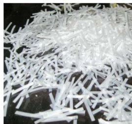
شکل ۲. الیاف نایلون مصرفی در این پژوهش
