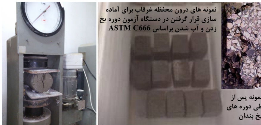
شکل ۳- چپ: نمونه ها قبل و بعد از آزمون یخ زدن و آب شدن، راست: مقاومت کششی دو نیم
