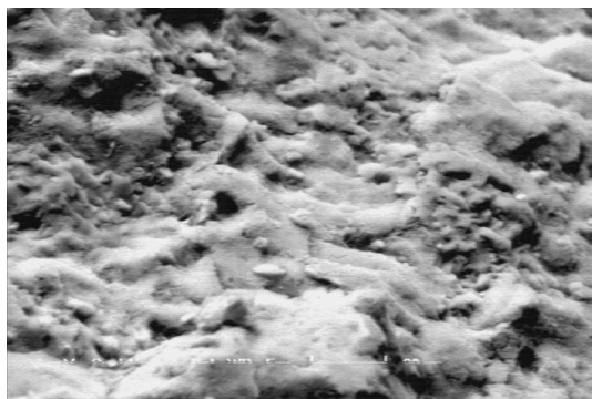
شکل ۵- ریزساختار ملات حاوی دوده سیلیس (۲۰۰°C)
