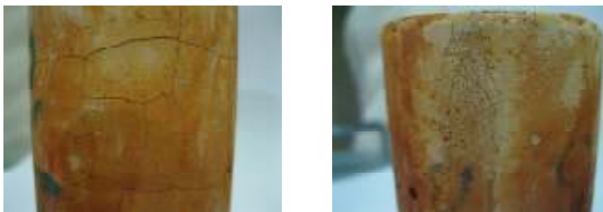
شکل ۱- وضعیت ظاهری نمونه‌های خمیر سیمان پس از قرارگیری در محلول اسید نیتریک
