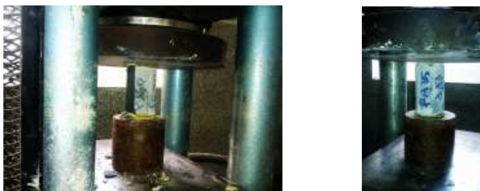
شکل ۴. دستگاه آزمایش مقاومت فشاری
