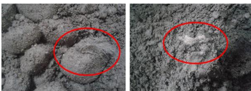
شکل (۱۱) - نمونه ای از تویی شدن الیاف پلی پروپیلینی در داخل بتن غلتکی
