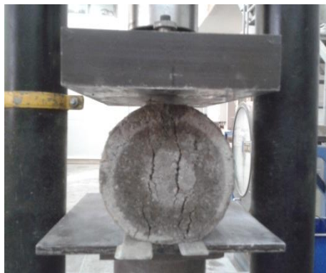
شکل ۲-۳ - تغییر شکل نمونه بتنی با افزودن الیاف
