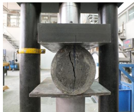
شکل ۱-۳ - تغییر شکل نمونه بتنی بدون الیاف
