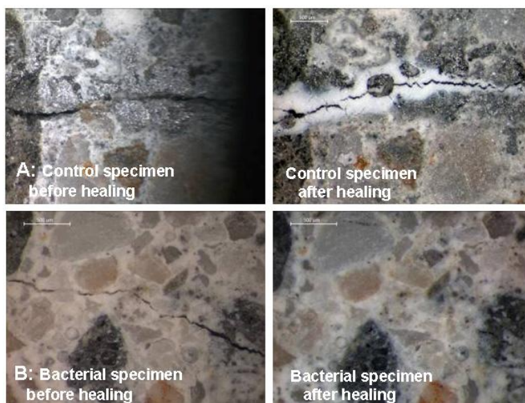
شکل ۵- تصاویر میکروسکوپ نوری A- نمونه ترک دار اولیه، B- نمونه باکتریایی. نمونه سمت چپ قبل از فعالیت باکتری و نمونه سمت راست بعد از فعالیت باکتری می باشد. رسوب کربنات کلسیم در دهانه ترک به وضوح در نمونه حاوی باکتری مشهود است [۲۹].
