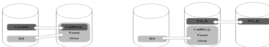
شکل ۷- کیسولهای حاوی مواد متفاوت (A) سیلیکاژل، (B) فوم پلی یورتان استفاده شده برای غیر متحرک کردن مواد باکتریایی پر کننده ترک [۲۰].
