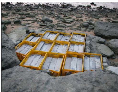
شکل ۱- آزمونه‌های منشوری در ناحیه جزر و مدی در جزیره قشم
